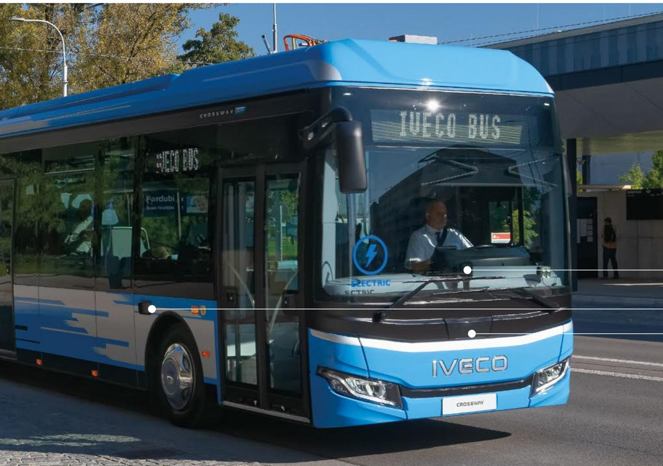
Ces outils de détection sont intégrés dans un capteur radar installé sur la face avant du véhicule et une caméra, placée derrière le pare-brise, balaie l'ensemble de la partie avant depuis l'intérieur. Cette association permet de détecter les usagers de la route vulnérables en approche frontale et latérale, ainsi que les panneaux de signalisation. La caméra est équipée d'un capteur de luminosité permettant l'allumage automatique des phares avant.
