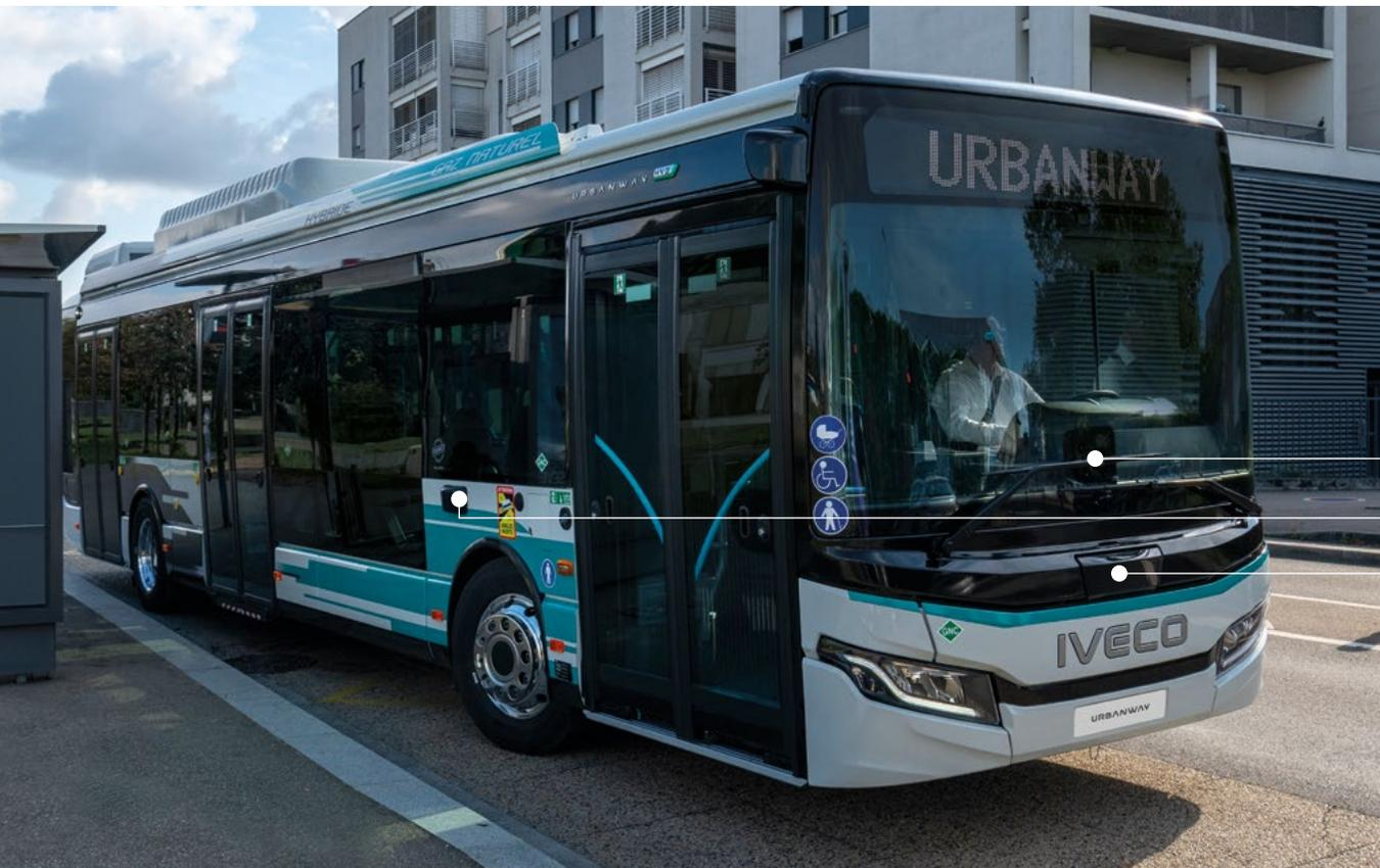
Ces outils de détection sont intégrés dans un capteur radar installé sur la face avant du véhicule et une caméra, placée derrière le pare-brise, balaie l'ensemble de la partie avant depuis l'intérieur. Cette association permet de détecter les usagers de la route vulnérables en approche frontale et latérale, ainsi que les panneaux de signalisation. La caméra est équipée d'un capteur de luminosité permettant l'allumage automatique des phares avant.
