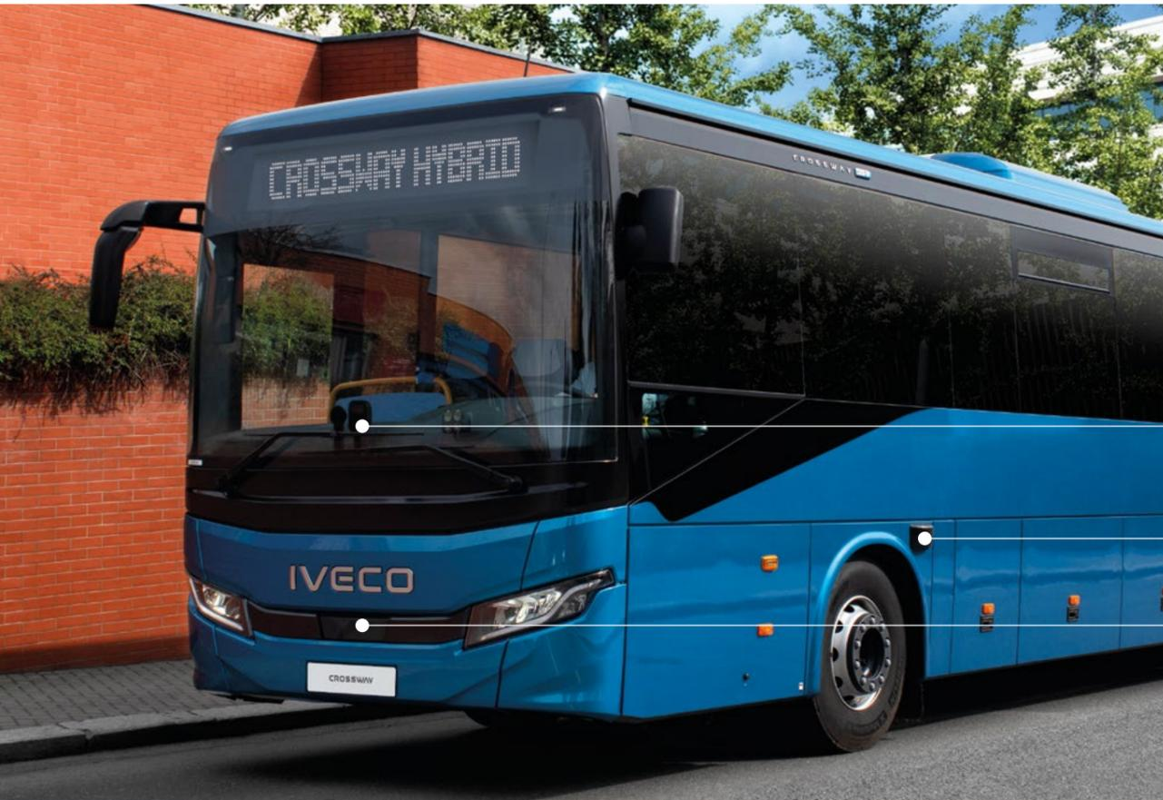
Die Assistenzsysteme verfügen über einen Radarsensor an der Fahrzeugfront und eine innenseitige Kamera hinter der Frontscheibe, die den gesamten Frontbereich abdeckt. Das Zusammenspiel all dieser Elemente ermöglicht die Erkennung von Verkehrszeichen sowie seitlich und frontal entgegenkommenden ungeschützten Verkehrsteilnehmern (Vulnerable Road User, VRU). Zur Kamera gehört ein Lichtsensor, der für die automatische Einschaltung der Frontscheinwerfer sorgt.
