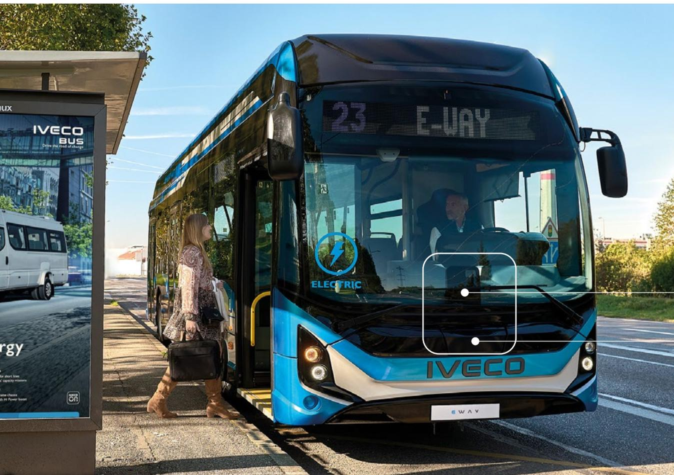
Un radar e una telecamera all'avanguardia, posizionati sul frontale del veicolo, garantiscono la massima sicurezza. Il radar monitora l'area davanti al veicolo, mentre la telecamera copre l'intera area frontale dal lato interno, dietro il parabrezza. Insieme, questi sistemi sono in grado di rilevare:
